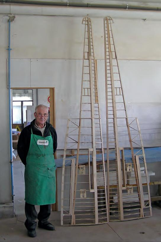
levatore. In questa fase fu determinante Horst Niederwanger, che nel frattempo aveva messo in funzione la sua attrezzatura autocostruita per il taglio e la fresatura di elementi in CNC e che si offrì di tagliarmi tutti gli elementi necessari. Le centine e le ordinate vennero tutte fresate da compensato di betulla e di pioppo, naturalmente in vari spessori; i longheroni, realizzati in lamellare di
