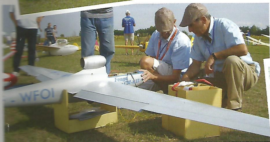
Bartolotta e Di Paolo accendono il propulsore a turbina Jetcat P20 del Fouga CM8-13
