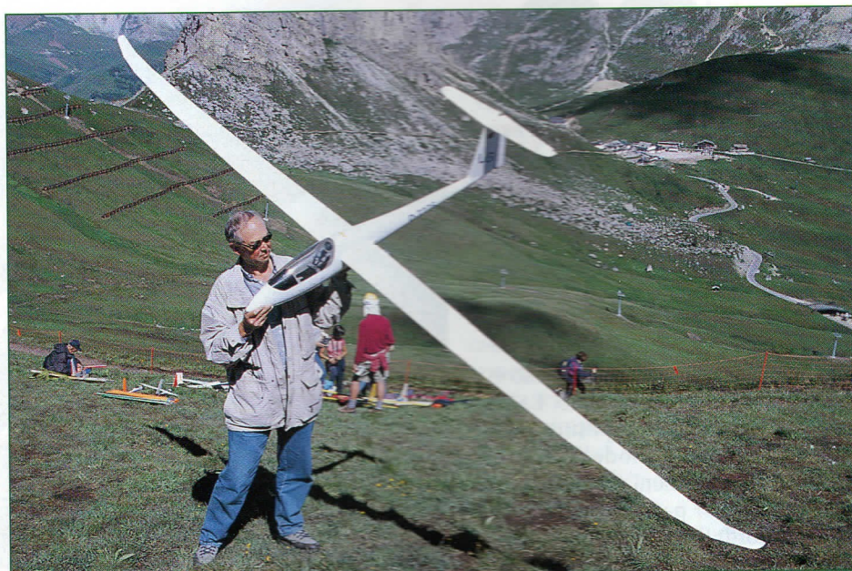
Il nuovissimo Ventus 2C di Uwe Gewalt; modello di 4 metri di apertura alare, 5 kg, 5 rastremazioni, profili HQ.
