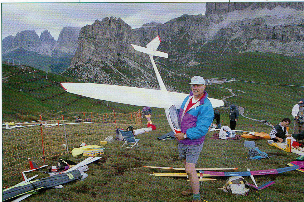
Sopra: Il trevisano Amato e la sua bella riproduzione dell'MG-19 A: ap. al. 4.40 m, kg 6.100, profilo E-201. Sotto: Vittorio Gazzarrini, presidente del GARC di Firenze con il Neon Speed ap. al. 3.15 m, peso kg 4, (carico alare 60 gr. Profili S-6060 nella prima rastre-mazione, S-6062 nelle due sezioni estreme.
