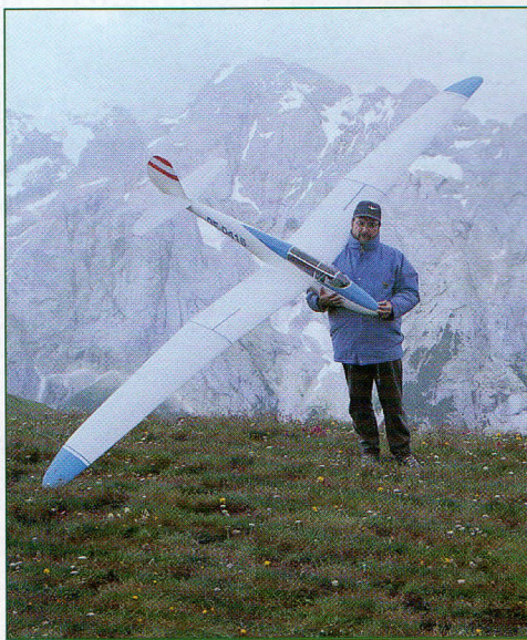
Sopra: Il trevisano Amato e la sua bella riproduzione dell'MG-19 A: ap. al. 4.40 m, kg 6.100, profilo E-201. Sotto: Vittorio Gazzarrini, presidente del GARC di Firenze con il Neon Speed ap. al. 3.15 m, peso kg 4, (carico alare 60 gr. Profili S-6060 nella prima rastre-mazione, S-6062 nelle due sezioni estreme.
