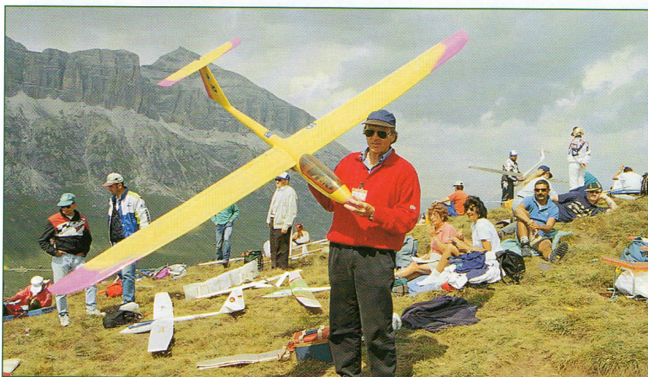
Herr Helmut Quabeck e il Rockmaster - Modello completamente stampato che impiega il nuovo profilo HQ/W-2/8.
