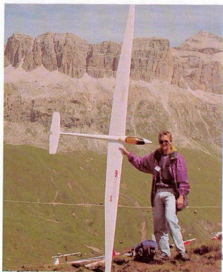
Una novità in scatola di montaggio: è l'ASW2 BE Vario della Graupner. Apertura alare variabile da m 3.55 a m 3.85 a mezzo di appositi terminali, e possibilità di motorizzazione elettrica.
