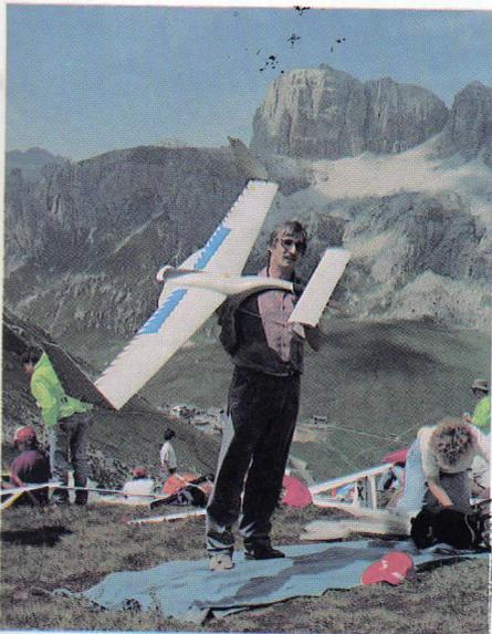
Un modello veramente particolare e dalle doti di volo sorprendenti: è l'anatra di Urs Siegl, realizzata in eposi (fusoliera), compensato, stiropor, carta (ala e piani). Apertura alare di m 2.80 per 3000 g di peso, profilo E 205 mod.
