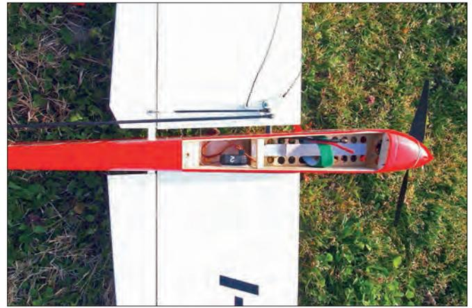
La struttura dell'I-CAMA in controluce ed un particolare del vano batteria e del muso raccordato col fortissimo disassamento del motore. A fianco e sotto: il Dacro 2 e l'evoluzione delle modifiche alla fusoliera ed al musetto per migliorare il raffreddamento della batteria.
