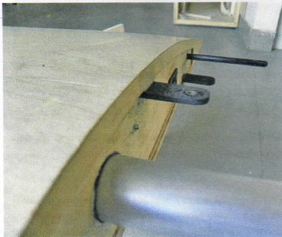
Flächenverbinder der linken Tragfläche aus 25-mm-Alurohr, innen mit Kohlerowings verstärkt.
