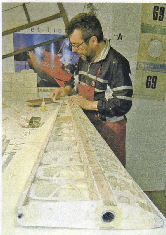
◀ Die linke Tragfläche im Bau. Insgesamt wurden ca. 3.000 Arbeitsstunden investiert.
