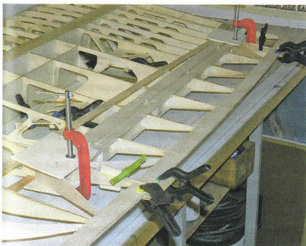
Einbau der Scharniere; sie bestehen aus GFK mit 2-mm-Carbonachsen.
